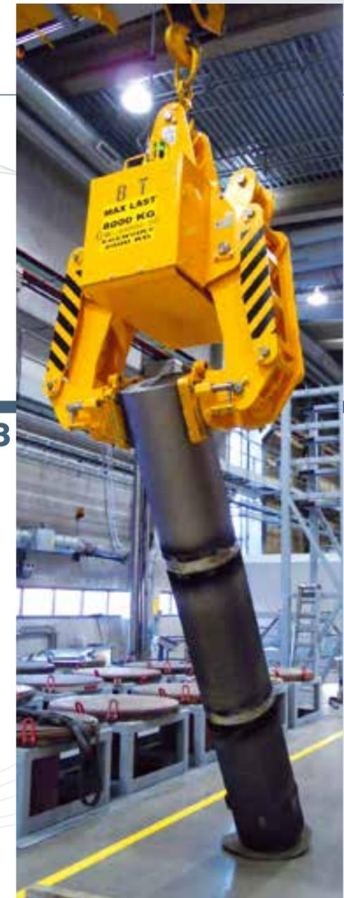
**1** Elektrohydraulische Blockzange für Rundblocktransport mit drehbaren Backen, geeignet für Vertikaltransport und zum Umlegen von Blöcken im Heißbetrieb.
