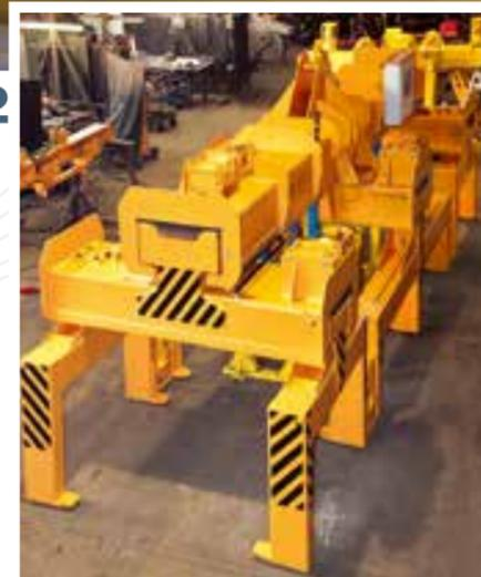
**1-2** Elektromotorischer Blechpaketgreifer mit 27t Tragfähigkeit. Der Greifer ist in der Länge und in der Breite teleskopierbar und kann somit sehr unterschiedliche Stapel aufnehmen.
