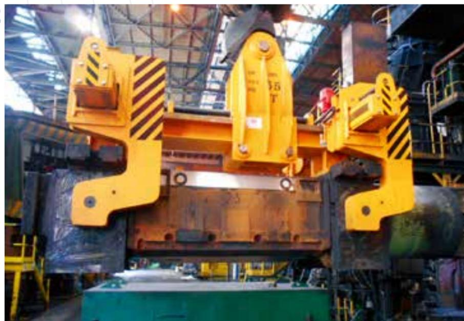
**1-2** Elektromotorische Stützwalzentransporttraverse, Transport an Baustücken, mit Schwerpunktausgleich
