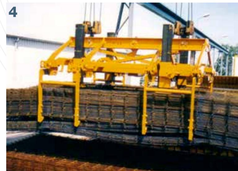
**1** Baustahlmattengreifer, Öffnen und Schließen mechanisch, elektromotorische Innenverstellung
