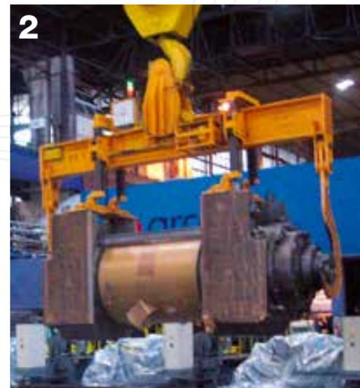
**1-2** Elektromotorische Stützwalzentransporttraverse zum Greifen von Stützwalzen mit Baustücken.
