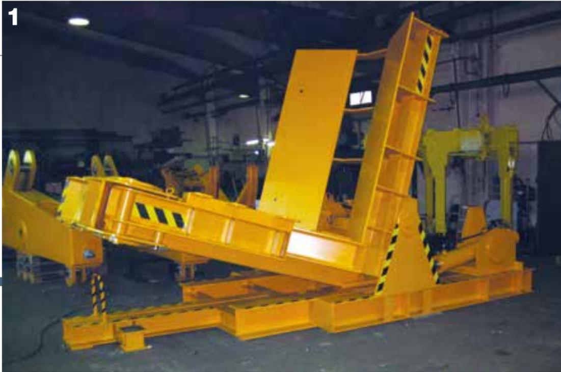
**1-3** Elektrohydraulischer Kipptisch mit ausklappbaren Auslegern für besonders große zylindrische Lasten (hier: Turmsegmente für Windenergieanlagen) mit sehr unterschiedlichen Durchmessern.
