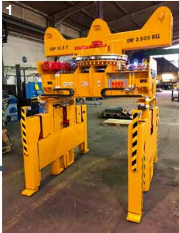
**1** Elektromotorischer Mehrfach-Teleskop-Blechpaketgreifer mit Drehwerk und drehbaren Füßen für geringen Platzbedarf
