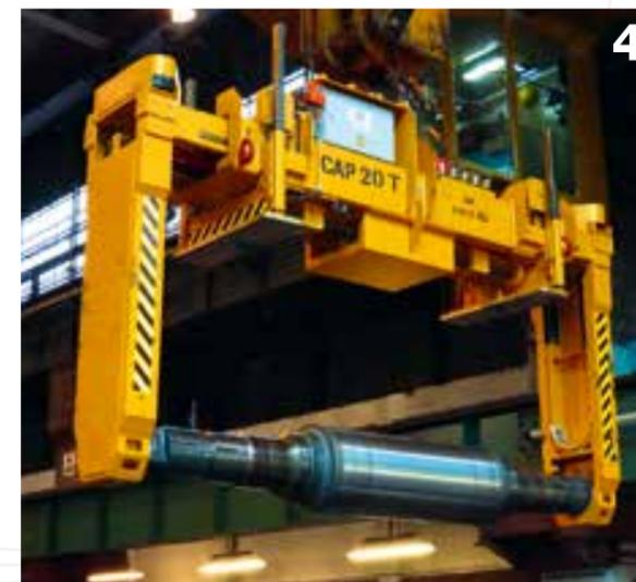
**3-4** Elektromotorischer Walzentransportgreifer zum Transport von einer oder zwei Arbeitswalzen. Die Arbeitswalzen werden dabei stirnseitig gegriffen.
