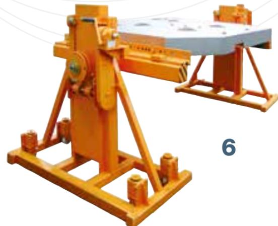
**7-9** Stationäre elektrohydraulische Werkzeugwendevorrichtung
