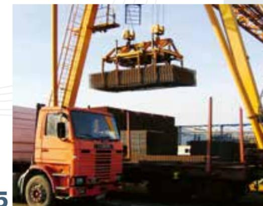
**4-5** Elektrohydraulischer Baustahlmattengreifer, innen greifend.
