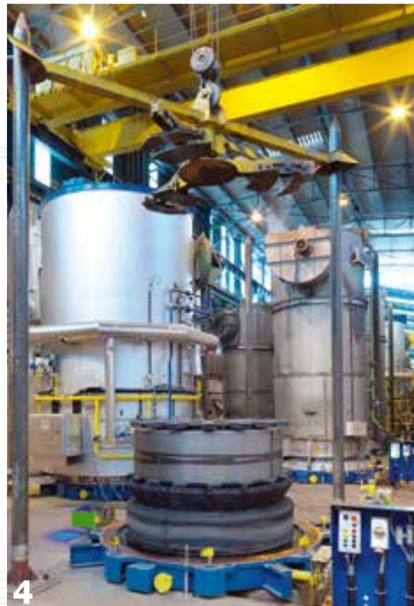
**5-7** Einfachverticalcoilzange mit Schrittschaltwerk.
